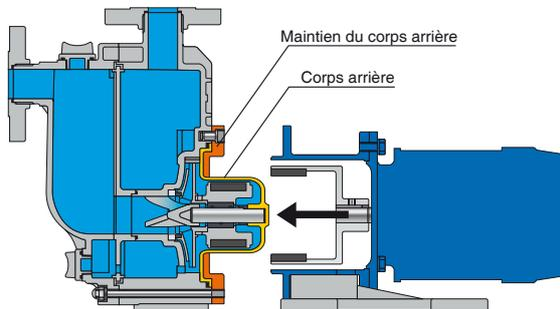
*La partie mouillée de la pompe est facilement démontable du moteur en enlevant les 4 vis de l'entretoise moteur.*
