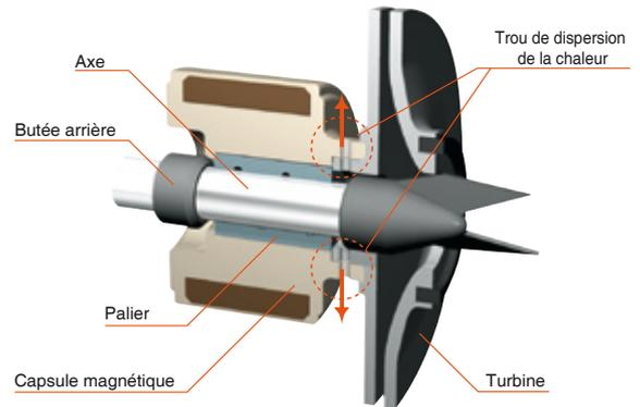
La puissance exceptionnelle des aimants utilisés évite le contact de la capsule magnétique avec la butée arrière et élimine de ce fait les risques de friction et d'échauffement avec fusion des matériaux synthétiques. De plus, notre structure de non-contact empêche le contact entre la face de la butée arrière et le palier, pour éliminer les montées de température durant la marche à sec.
